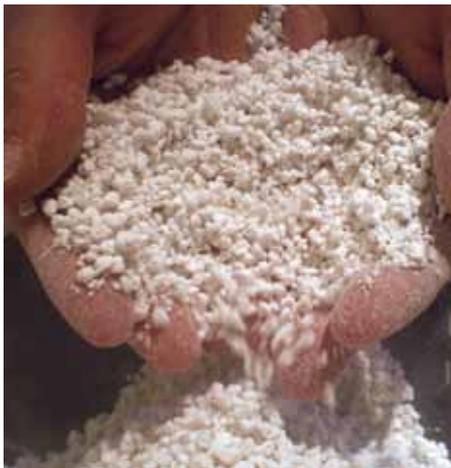
InterPARETE è un isolante a base di roccia vulcanica silicatica perlite, che ha la capacità di espandere il proprio volume fino a 20 volte rispetto a quello originale. L'espansione avviene a temperature comprese tra 850 e 1000° C ed è legata alla presenza di acqua rimasta chiusa nella roccia. La roccia si espande per la vaporizzazione dell'acqua: in questo processo si generano delle cavità all'interno dei granuli che le conferiscono ottime proprietà termo-isolanti e un'eccezionale leggerezza.
