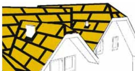
Con incollaggio di tutti i giunti dei pannelli come pure di tutti i raccordi e degli elementi emergenti dalla copertura tramite il nastro adesivo PAVATEX di 13 cm di larghezza. La „variante di si-
