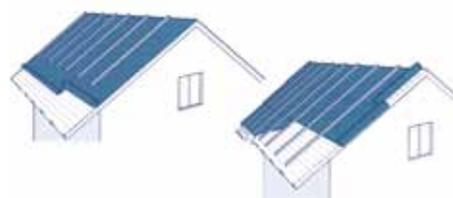
Per tutte le pendenze a partire da 5° proponiamo in alternativa ai pannelli ISOLAIR la posa del telo da sottocopertura STAMISOL, impermeabile all' acqua e permeabile al vapore acqueo.
