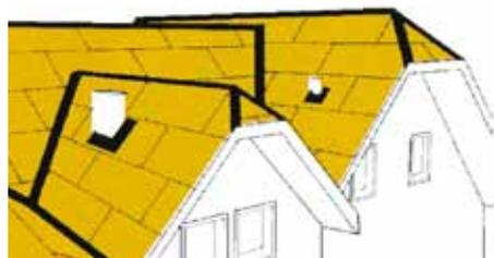
Senza incollaggio dei giunti dei pannelli, ma con incollaggio dei giunti ottusi dei pannelli come pure di tutti i raccordi e degli elementi emergenti dalla copertura. La „variante standard“
