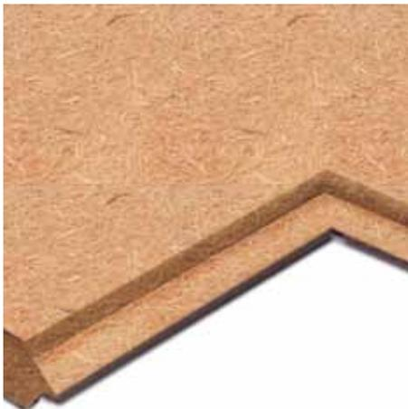
Per la loro applicazione speciale, i pannelli da sottotegola ISOLAIR vengono impregnati con lattice per renderli impermeabili all'acqua; inoltre sono dotati di robusti spigoli ad incastro maschio e femmina. Grazie al loro altissimo potere di diffusione del vapore acqueo ed alla loro eccellente igroscopicità, i pannelli vengono posati in opera direttamente
