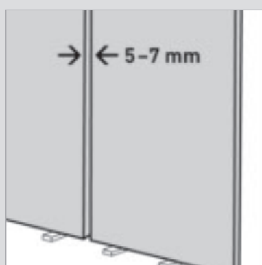
Larghezza della fuga ca. 5-7 mm o ½ spessore della lastra
