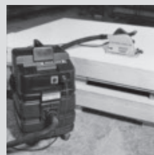
Sega circolare manuale con dispositivo di aspirazione
